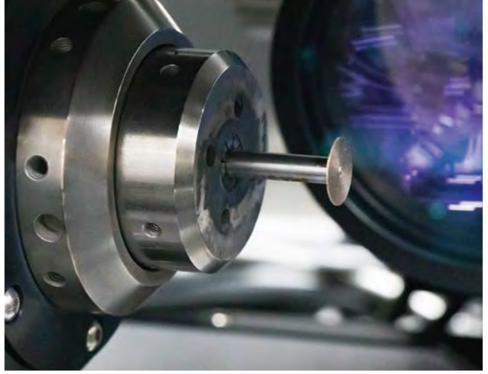
Schleifutensilien und Präzisionswerkzeuge für die Herstellung der Keramikimplantate fertigt Dentalpoint auf Aerotech-Fertigungssystemen mit Laserbearbeitung.
