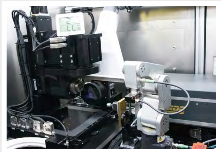
Kompaktes 7-Achssystem aus 5 Schwenkachsen und 2 optischen Achsen: der Massenschwerpunkt ist exakt im Toolcenterbereich positioniert, wo ein Werkzeug mit integrierter Helixbewegung ausgelasert wird.
